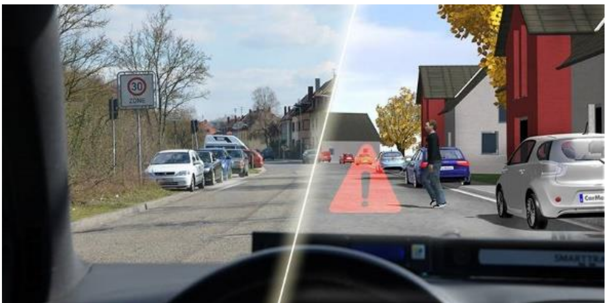
Test eines Notbremsassistenten im Vehicle-in-the-Loop-Versuch
