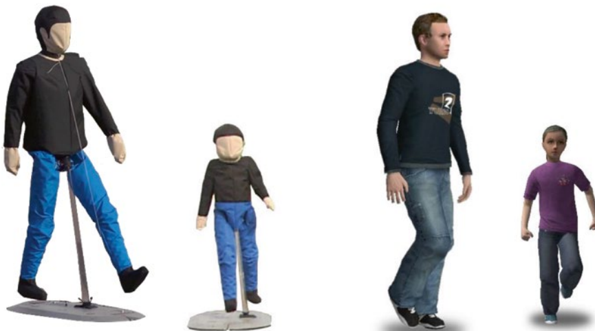
BILD 1 Reale Euro NCAP Pedestrian Targets (EPTa und EPTc, links) versus virtuelle Fußgänger (Erwachsener und Kind, rechts) (© Euro NCAP und IPG Automotive)
