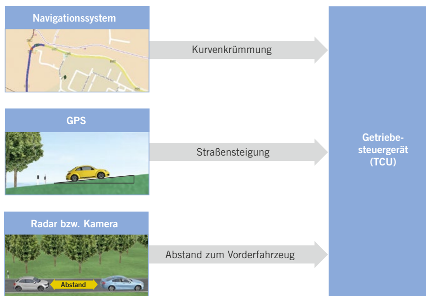
BILD 3 Informationen, die durch Sensoren erfasst und an die Getriebe-Software weitergegeben werden (© IPG)
