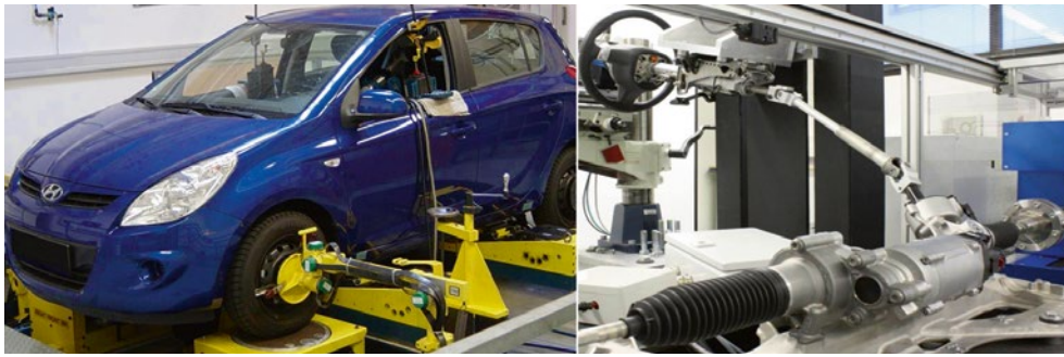
BILD 3 Fahrzeug-Prüfling (links) auf dem Fahrwerkprüfstand, um das elastokinematische Verhalten (K&C) im HMETC in Rüsselsheim zu testen, und Lenksystem (rechts) auf dem Lenkungsprüfstand der Hochschule München
