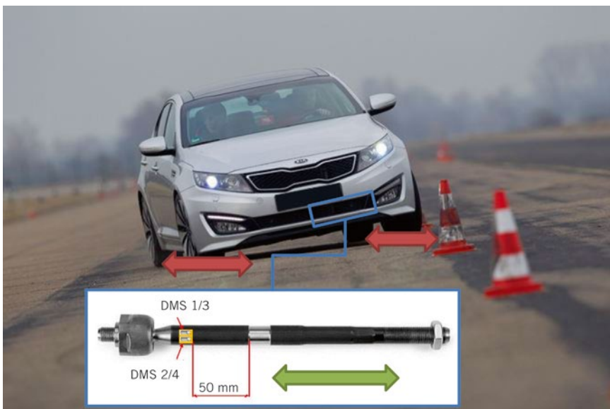
BILD 2 Objektive Fahrversuche auf dem Prüfgelände mit Messung der Zahnstangenkräfte per DMS auf den Spurstangen
