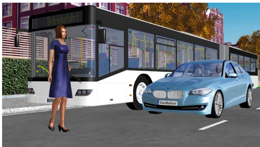
❶ Anwendungsszenario des Notbremsassistenten für Fußgänger für die Vehicle-in-the-Loop-Methode
