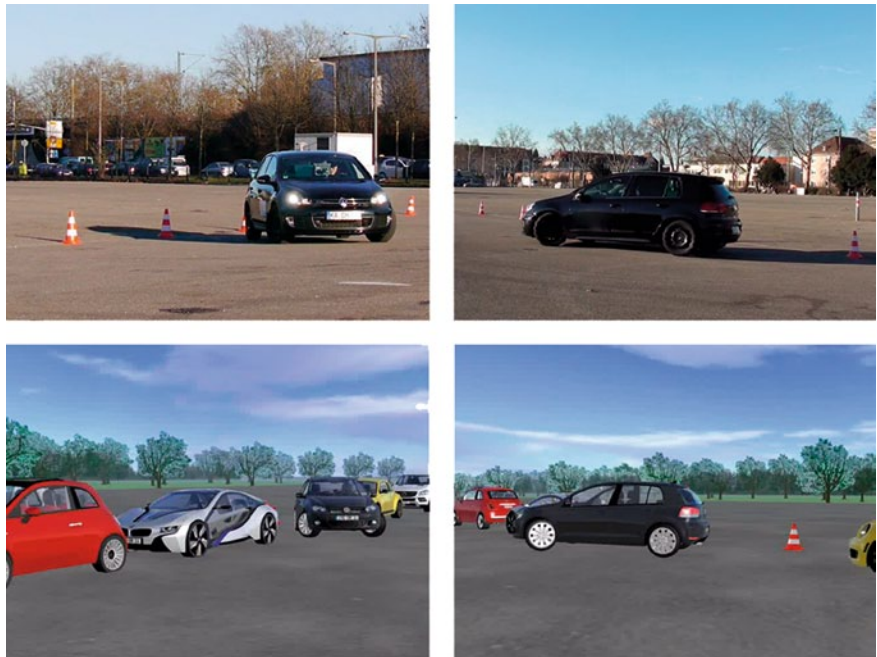
② Reales Einparkmanöver (Bilder oben) und in der ViL-Testumgebung (Bilder unten)
