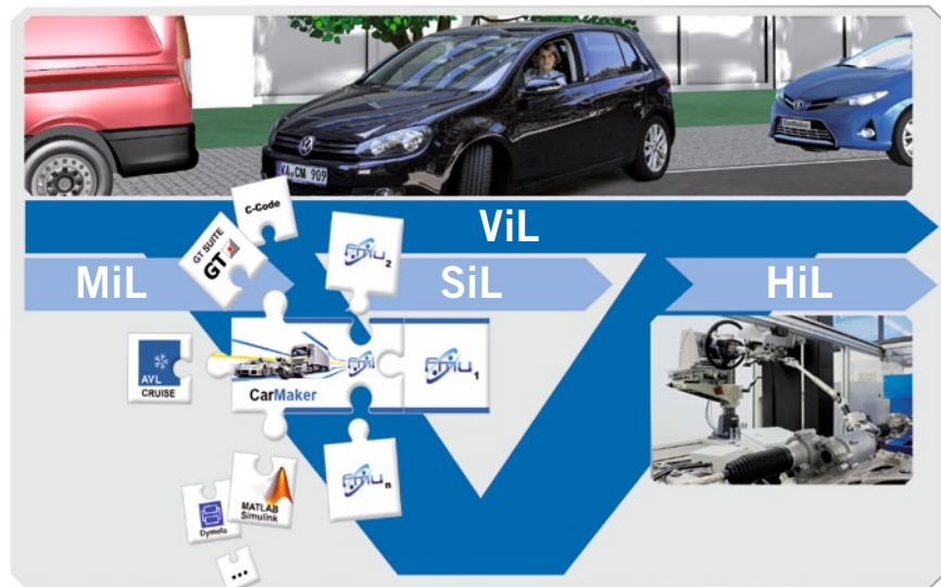
5 Durchgängigkeit der ViL-Methode im V-Prozess
