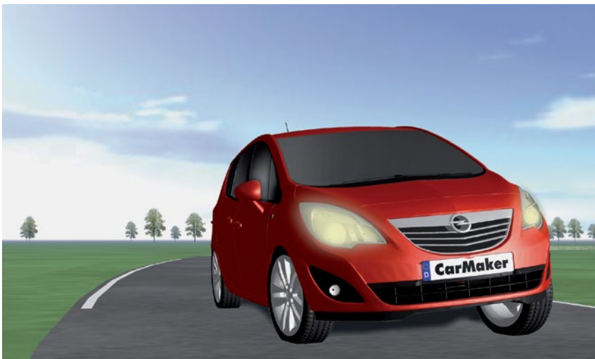
③ Visualisierung des CarMaker-Fahrzeugmodells zur ESP-Homologation
