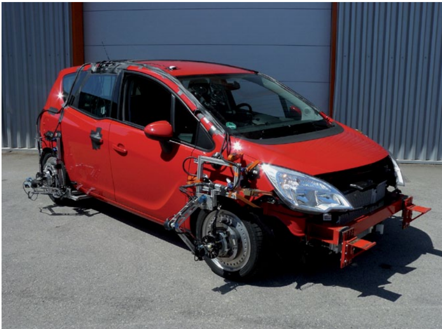
② Referenzfahrzeug Opel Meriva mit Idiada-Instrumentierung für Fahrdynamikversuche
