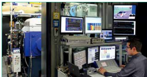
エンジンベンチで、様々なシャシ向けのエンジンキャリブレーションとテスト
