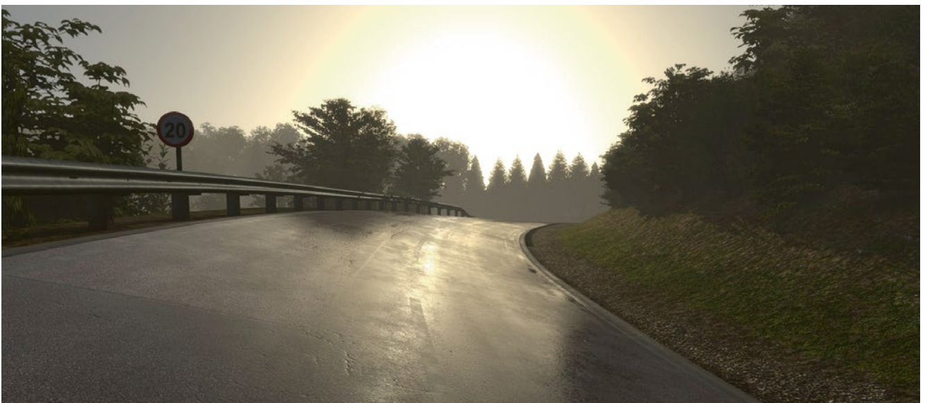
BILD 1 Aufgrund von Witterungsbedingungen und Sonnenstand ergeben sich Corner Cases für die Erkennung von Fahrbahnmarkierungen (© rFpro)
