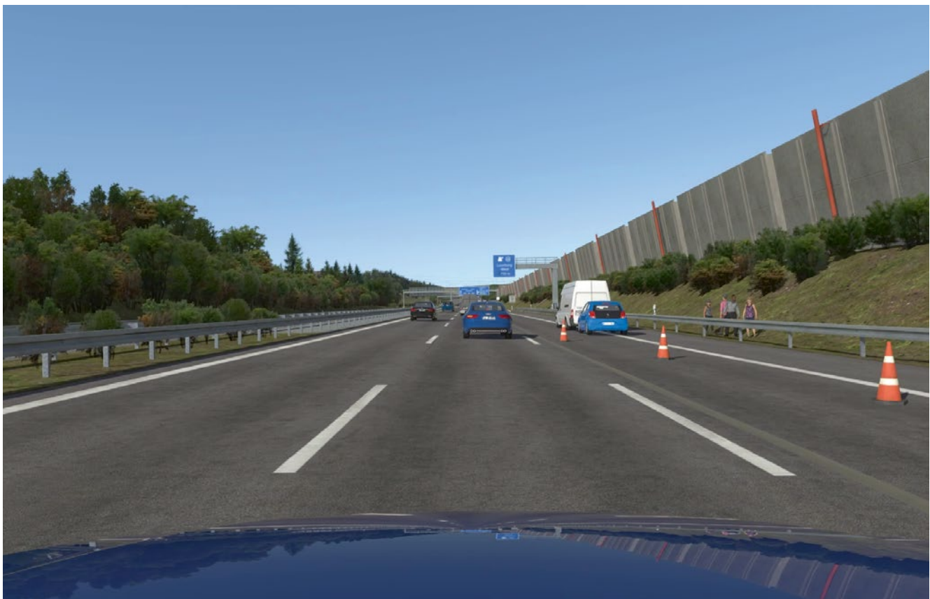
BILD 6 Frei konfigurierbare und reproduzierbare Generierung von beliebigen seltenen Verkehrssituationen (© rFpro)
